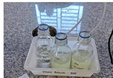
Figura 1 - Sistema montado (Frascos, mangueiras de silicone e pedras difusoras)
