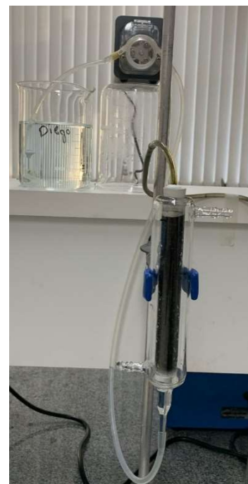
Figura 1. Montagem experimental dos ensaios cinéticos em coluna
