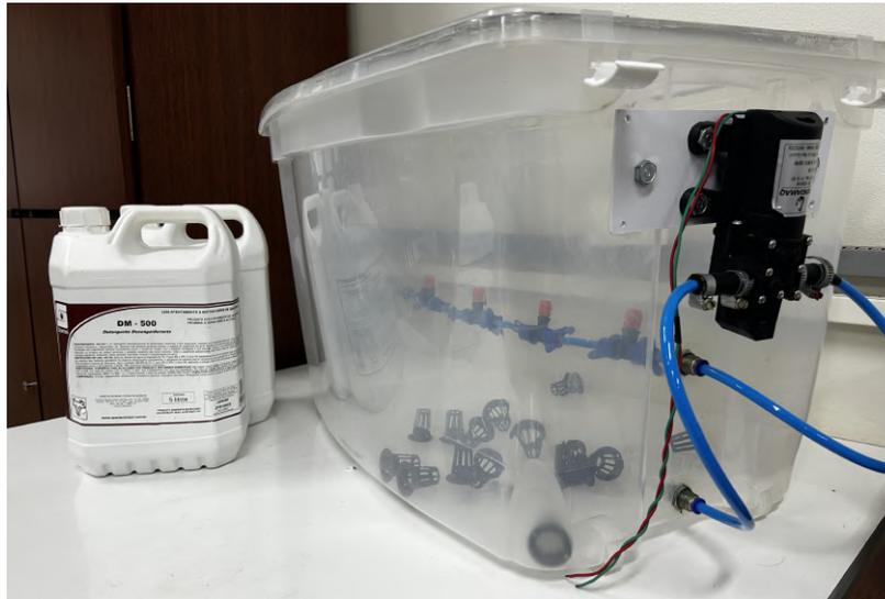
Figura 5: Protótipo piloto da caixa de aeroponia. Os galões na esquerda contém a solução nutritiva a ser utilizada. A caixa transparente é a caixa de Aeroponia. No interior, há o sistema de aspersão de solução nutritiva. Na lateral, está acoplada a bomba hidráulica para envio de solução nutritiva para as mangueiras de aspersão. Os potes pretos dentro da caixa são os potes de cultivo, que serão posteriormente instalados na tampa.
