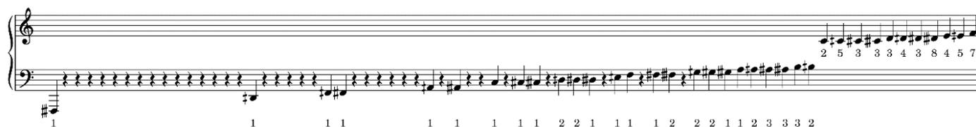
Figura 3- Partitura musical representando os modos de vibração da sala *Dolby Atmos*, da JLS. Podemos observar buracos na resposta de frequência representados pelas pausas de semínima, e como a distribuição fica mais contínua conforme diminui o comprimento de onda
