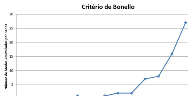
Figura 2- Curva de Bonello gerada a partir dos modos de vibração da sala *Dolby Atmos* da JLS
