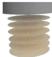
**Figura 4:** Esquema ilustrando a sobreposição das camadas impressas que formam a membrana porosa
