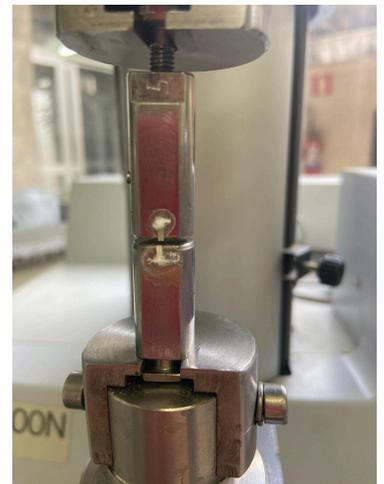
Figura 3. Realização do ensaio mecânico de resistência à microtração em Máquina Universal de Ensaio (EZ Test).
