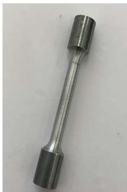
Figura 14 – Corpo de prova fabricado para o ensaio de tração
