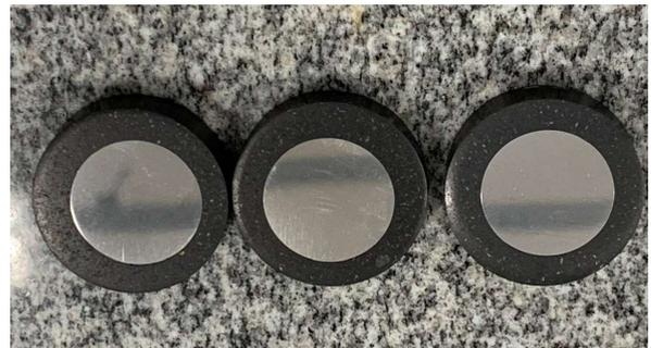
Figura 15 – Corpos de prova para o ensaio de dureza.
