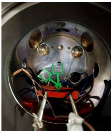
Figura 4 – Imagem do suporte mecânica para o filtro de referência (central) e de teste (à esquerda).
