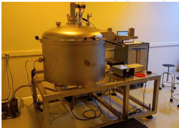
Figura 2 – Evaporadora a vácuo presente no Laboratório de Léptons.
