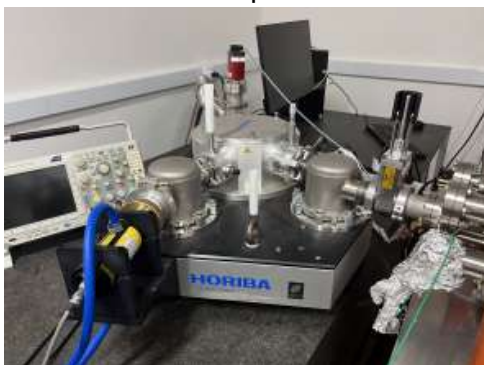
Figura 3 – Monocromador utilizado para testes de eficiência com as amostras, localizado no Laboratório de Léptons.
