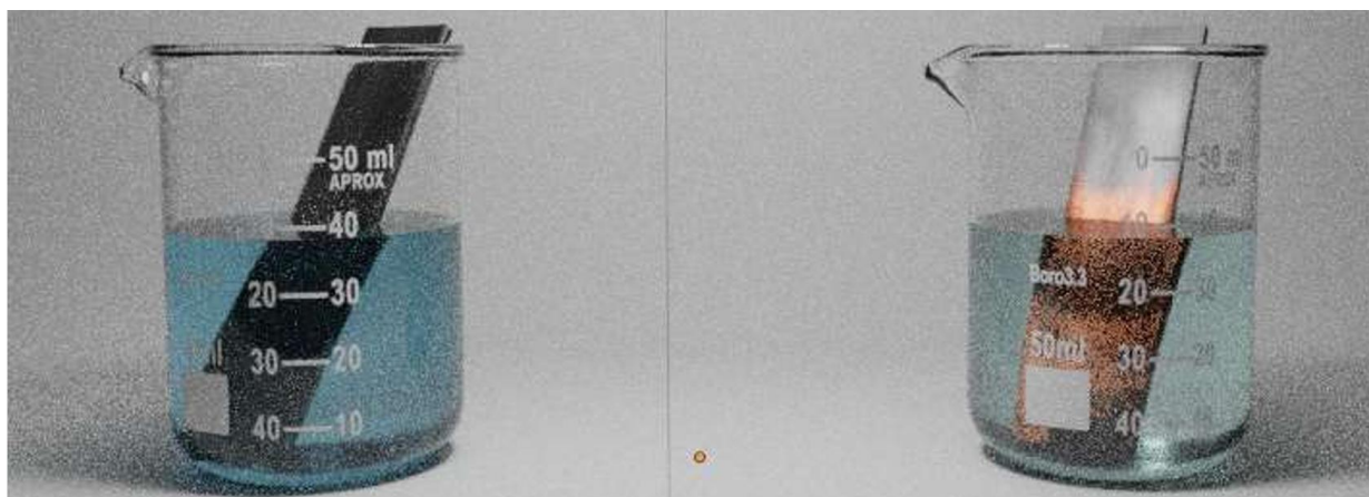
Figura 3: Processo de criação das animações, com zoom para a corrosão de uma placa de zinco metálico em uma solução de sulfato de cobre II.
