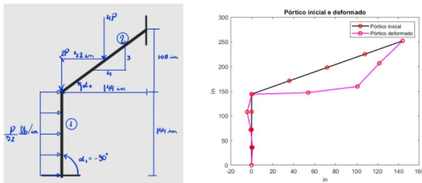
Figura 4 – Pórtico analisado e resultado para 8 elementos
