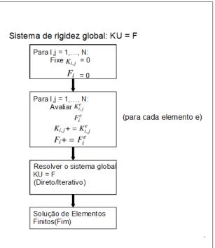
Figura 1 – Montagem da Matriz de Rigidez do Método de Galerkin – Fonte: Imagem própria
