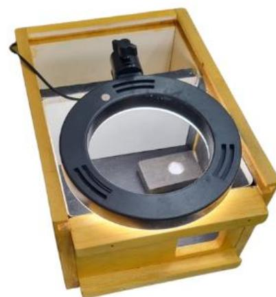
Figura 1. Caixa para análise pelo *PhotoMetrix PRO*.
