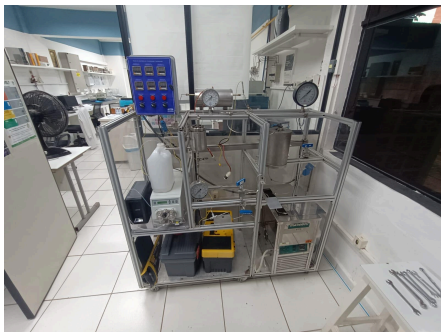
Figura 1. Unidade de Hidrólise utilizada nesse estudo, construída e patenteada pelo laboratório BIOTAR.
