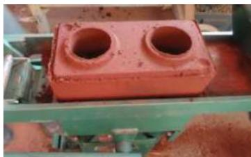
Fig. 3 – Tijolos solo cimento (Fonte: Ferrari et al., 2014)
