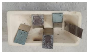
Figura 2: Material depositado antes de passar pela calcinação em forno tubular
