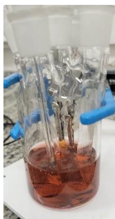
Figura 1: Eletrodeposição de cobre e cobalto sobre a placa de titânio
