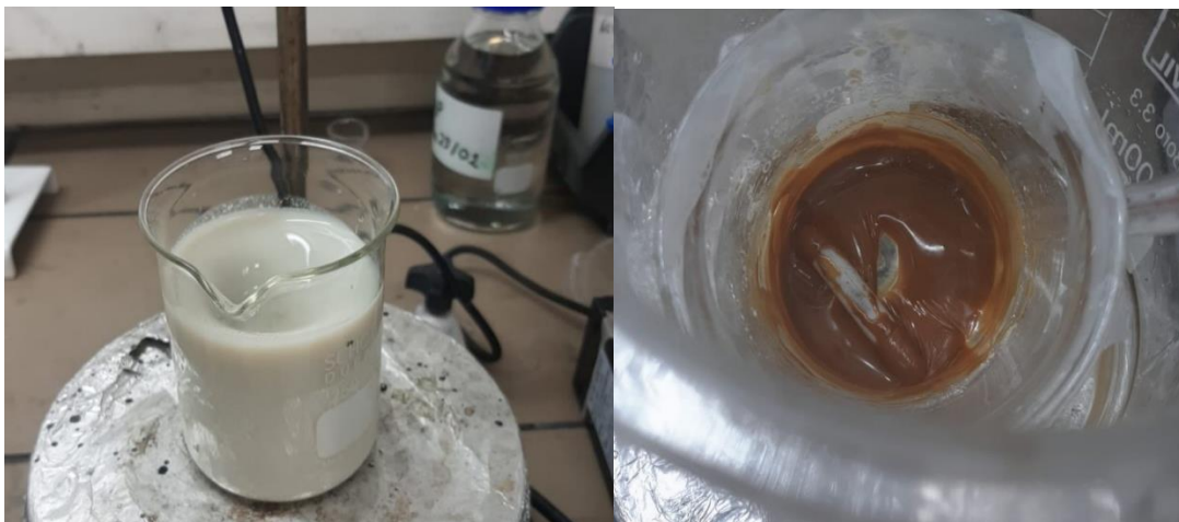
Figura 2: síntese de coprecipitação e síntese de sol-gel, respectivamente.
