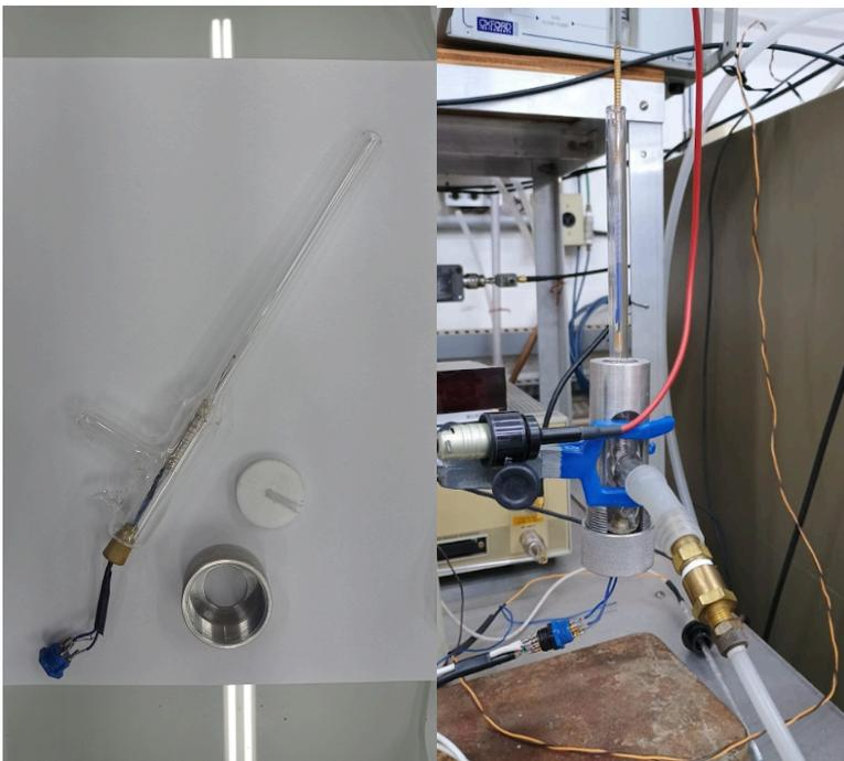
**Fig 1:** Dewar e sistema de aquecimento. O Dewar foi feito de quartzo e selado a vácuo. O heater foi feito usando um filamento de níquel-cromo e ligado a um sensor de temperatura PT-100
