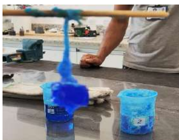
Figura 1. Aparato experimental para a formação de cristais de sal.
