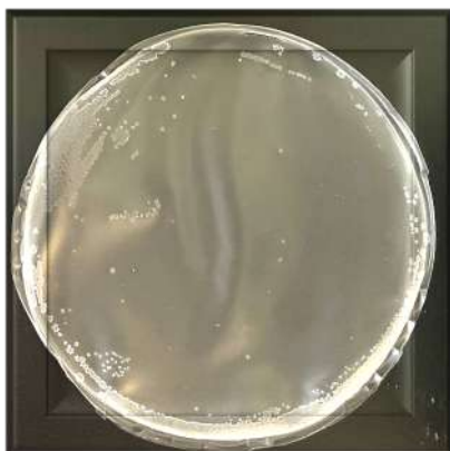
Figura 7. Polímero natural após 24 h de secagem à 27°C.
