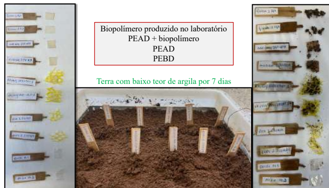
Figura 8. Corpos de prova antes, durante e após o ensaio de biodegradação.
