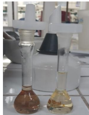
Figura 3: Solução de nanopartículas de prata (AgNP) feitas a partir do extrato de chá Matte nas concentrações de 1%, à esquerda e 10% à direita.
