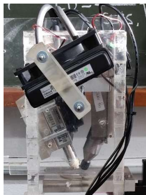
Figura 2- Espectrômetro de FRX
