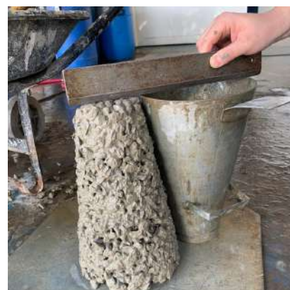
Figura 1: Ensaio de abatimento do concreto
