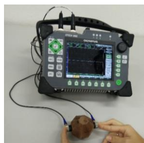
Figura 1. Poliedros de 18 faces (a) e ensaio de ultrassom no poliedro (b).
