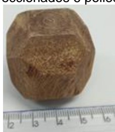
Figura 1. Poliedros de 18 faces (a) e ensaio de ultrassom no poliedro (b).
