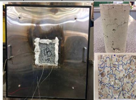
Figura 1: Forno utilizado na simulação de incêndio e as mostras pós- incêndio.
