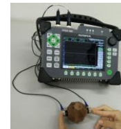
Figura 1. Ensaio de ultrassom no poliedro.
