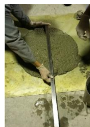
Figura 1. Slump Flow Figura 2. Funil V Figura 3. Caixa L
