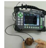
Figura 1. Ensaio de ultrassom no poliedro.
