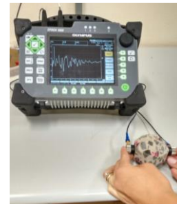
Figura 2. Ensaio em corpo de prova poliédrico de concreto.
