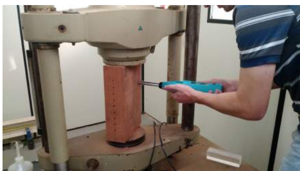
Figura 1. Esclerometria aplicada em prisma comprimido.
