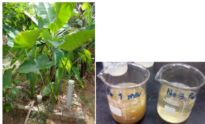
Figura 2. BET implantada na zona rural com bananeiras e taiobas e imagens do efluente inicial (esquerda) e final.
