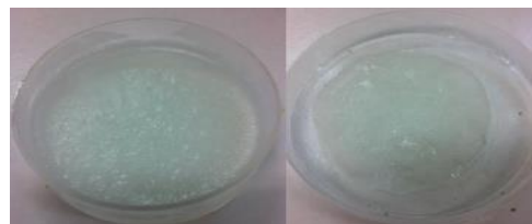
Figura 1. Hidrogel 3% na proporção 1:1 de colágeno e gelatina na placa de petri e após lavagem.
