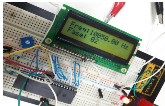
Figura 2. Microcontrolador PIC18F4550 com um display LCD 16x2 utilizado como visor, para mostrar as medidas em tempo real.
