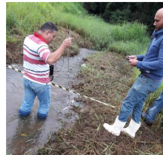
Figura 1. Processo de medição usando o micro molinete. Essa medição refere-se a 2ª campanha.
