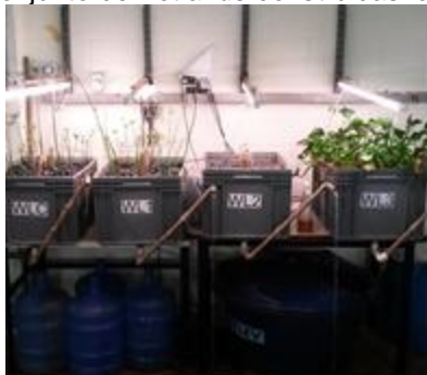
Figura 1. Conjunto de wetlands construídas laboratoriais.
