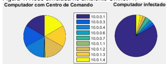
Figura 2: Análise via Matlab da comunicação entre o centro de comando da botnet e um computador infectado na rede da Figura 1.
