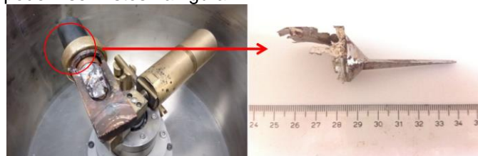
Figura 1. Detalhes do equipamento de fundição por centrifugação e do produto
