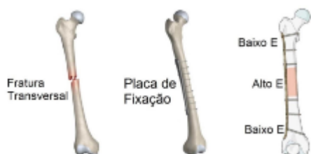
Figura 1. Esquema ilustrativo da placa de fixação óssea e das regiões com diferentes módulos de elasticidade 2 .
