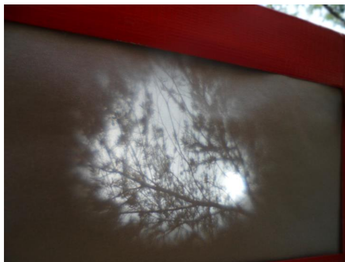
Figura 2. Árvore fotografada com o dispositivo de caixa de sapato embalada com papel vegetal.
