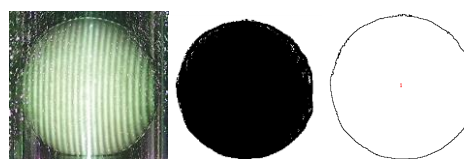
Figura 1: (Esquerda para direita) Fotografia da esfera no interior da câmara | Sombra da esfera | Silhueta da esfera
