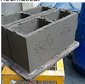
Figura 1. Blocos de concreto após a moldagem na máquina pneumática.
