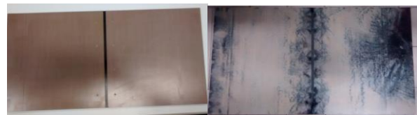
Figura 2. Placa antes e após a descarga elétrica.
