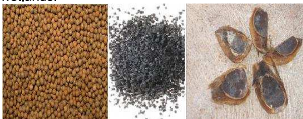
Figura 01. Materiais suportes utilizados nas wetlands - argila expandida, pneus picados e cascas de coco verde.
