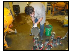
Figura 2 – Moldagem de CP
