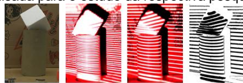
Figura 1: objeto a ser analisado; figura 2: objeto com projeção da grade com 1 cm de distância entre as linhas; figura 3: objeto com projeção da grade com 2 cm de distância entre as linhas; figura 4: projeção da grade sobre o objeto com 2 cm de distância entre as linhas em 8-bits.
