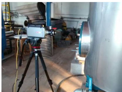
Figura 1. Equipamento tipo jato cavitante com a câmera de alta velocidade, Phantom V 7.3, instalada.
